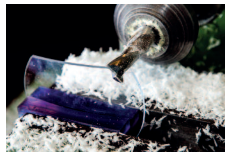
Abb. 5: Versuchsanordnung der HFAK-Studie: das Spanvolumen pro Glas ist das gleiche wie beim Randan mit konventionellen Randbearbeitungsautomaten mit dem Unterschied, dass Späne „geschält“ werden, statt mit Diamant „geschlagen“. Foto: Flo Bergmann
