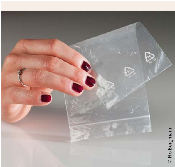
Abb. 6: PE, die klassische Plastiktüte; hauchdünn ist sie noch durchsichtig, aber bereits bei vier Lagen entsteht eine undurchsichtige Trübung.
