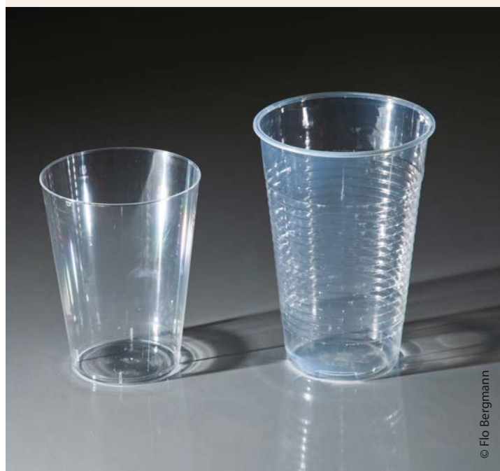
Abb. 3: Zwei Polystyrol-Joghurtbecher: links glasklar ohne Weichmacher, rechts leicht getrübt mit Weichmacher versetzt; beide sind lebensmittelchemisch zugelassen.
