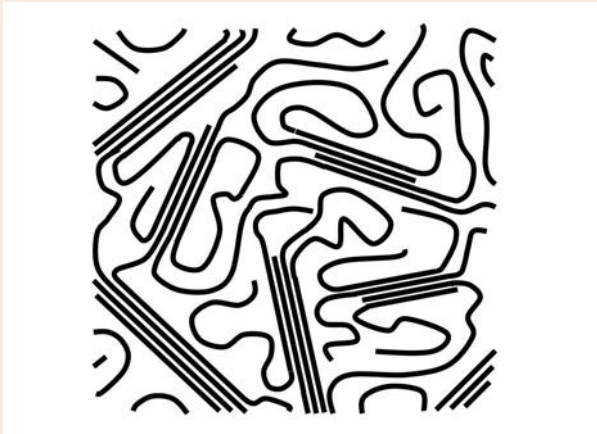
Abb. 4 links: Schematische Darstellung der Fadenmoleküle des PA; die Micellen sind kristalline Bündelungen von Makromolekülen auf engerem Raum, der amorphe Bereich ist weniger dicht bepackt.
