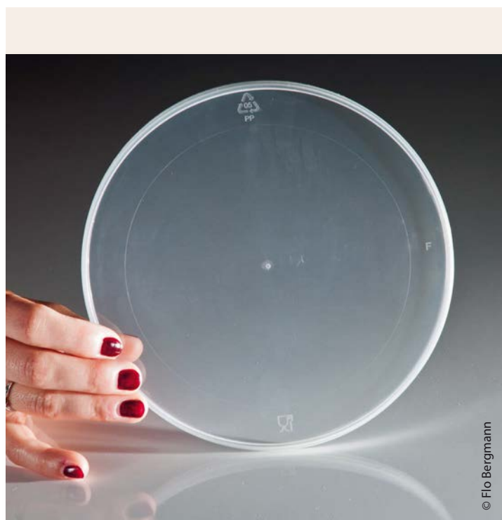
Abb. 2: Polypropylen (PP) als Lebensmittelbehältnis; oben der Recyclingcode, unten das Lebensmittel-Unbedenklichkeitszeichen; das Produkt ist weichmacherfrei.
