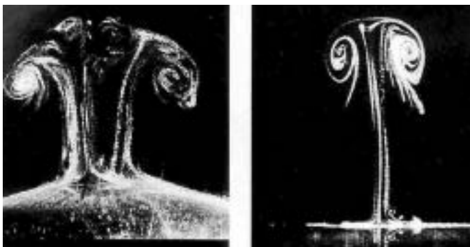
Abb. 2: Durch den Einschuss eines Excimer-Lasers verdampft Gewebe im Bruchteil einer Sekunde.
